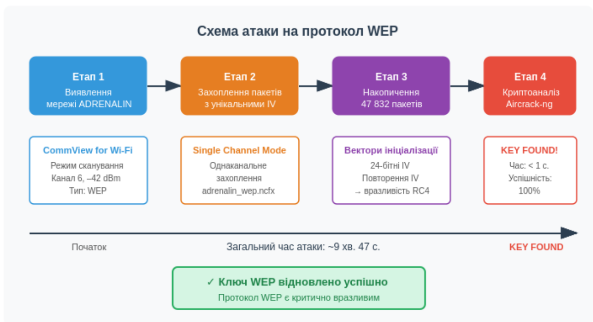
Рисунок 3.2 - Схема етапів лабораторного дослідження захищеності WEP
