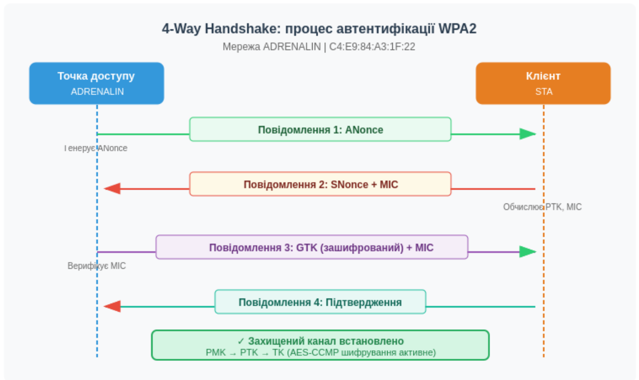
Рисунок 3.6 - Схема процедури 4-Way Handshake у WPA2-Personal
