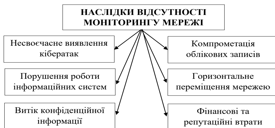
Рис. 1.3 — Основні наслідки відсутності моніторингу стану мережі
