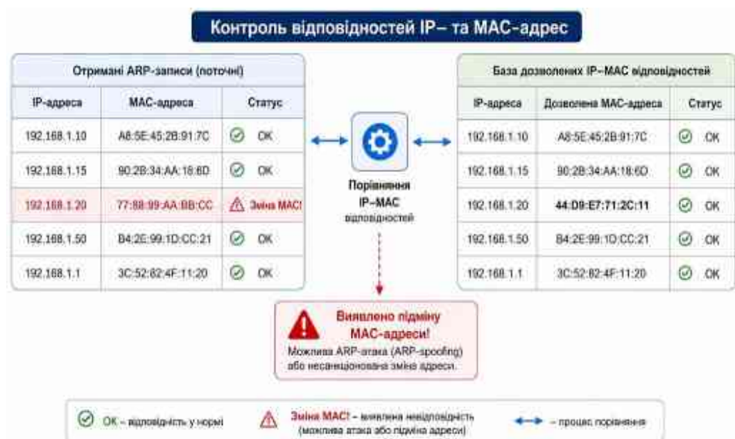
Рис. 2.5 — Контроль відповідностей IP- та MAC-адрес для виявлення аномалій
