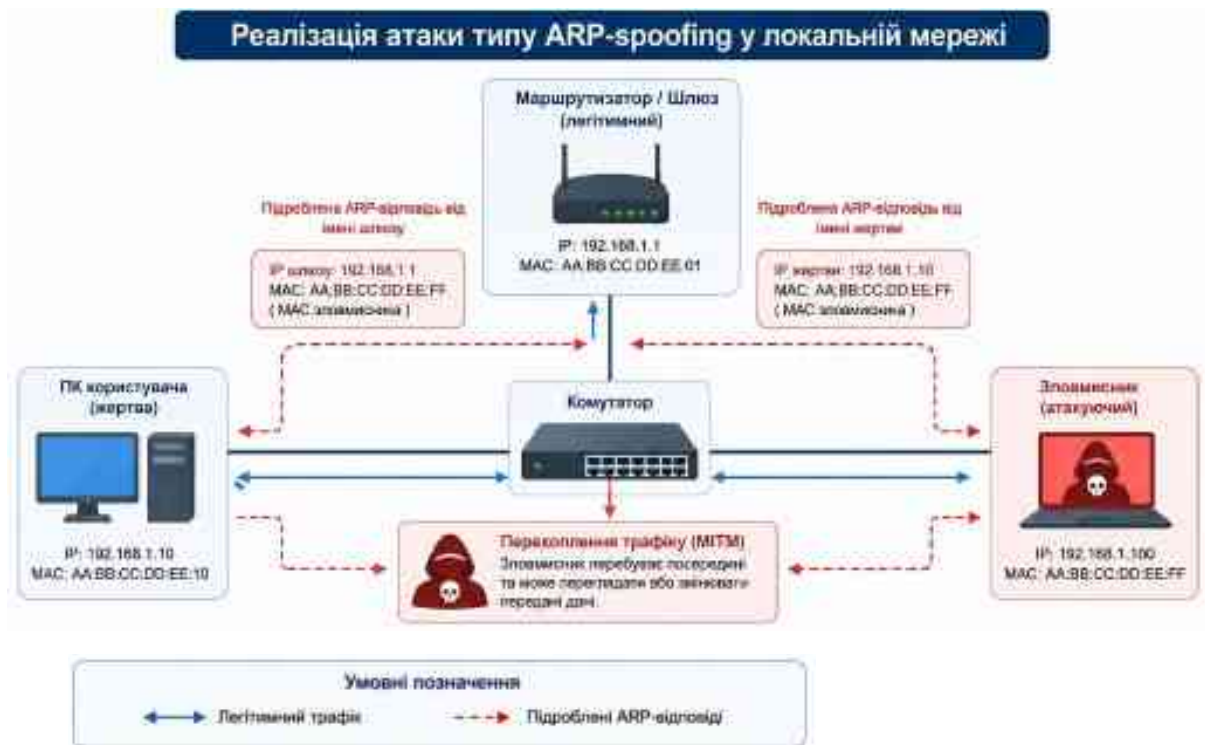
Рис. 2.3 — Схема реалізації атаки типу ARP-spoofing у локальній мережі
