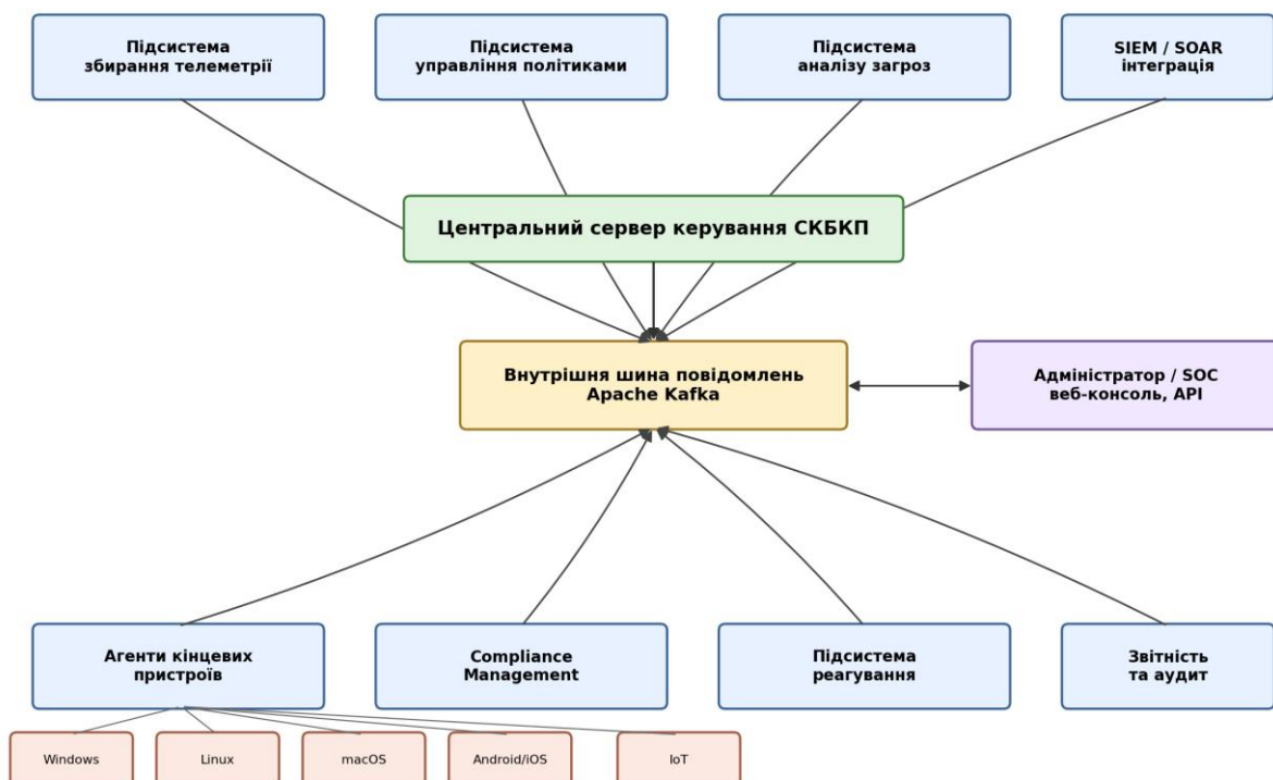
Рисунок 3.1 – Структурна схема системи контролю безпеки кінцевих пристроїв
