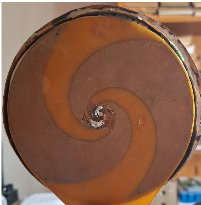
Рисунок 2.17 – Загальний вигляд досліджуваної планарної спіральної антени
