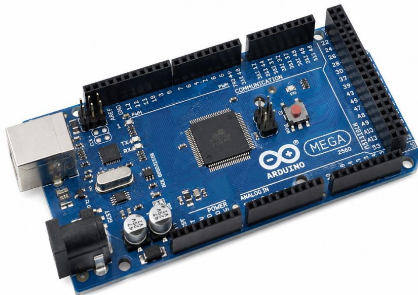
Рисунок 2.3 – Мікроконтролерна плата Arduino Mega 2560
