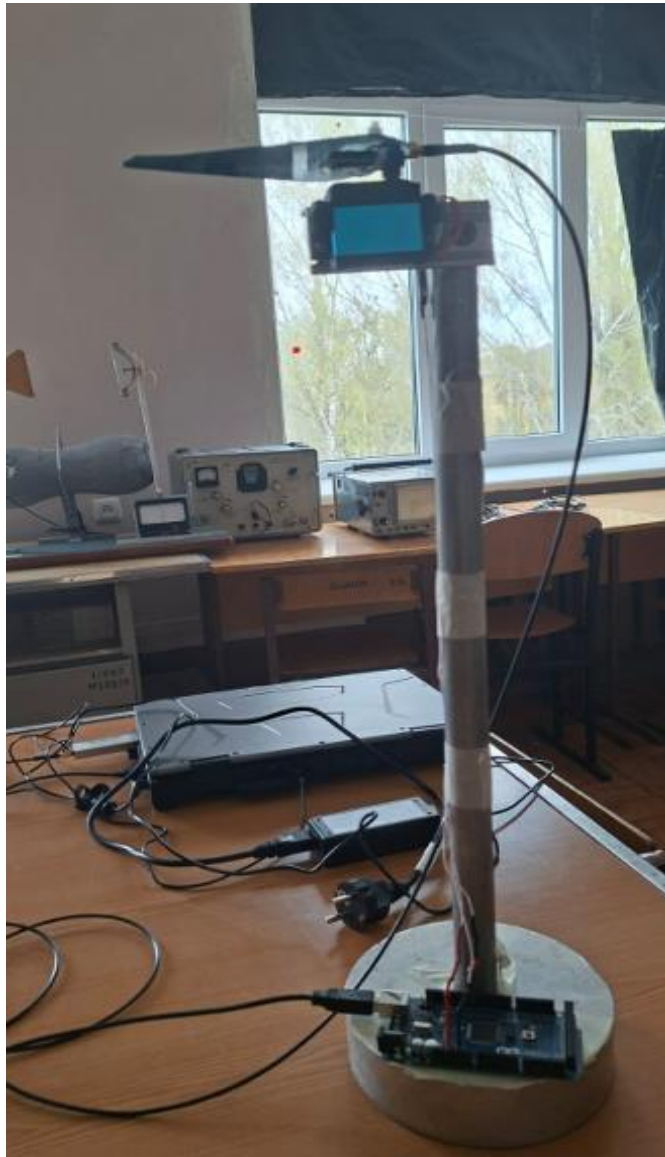
Рисунок 3.5 – Загальний вигляд автоматизованої установки для вимірювання діаграми спрямованості антени
